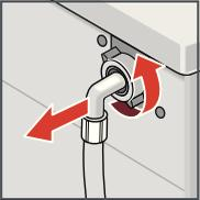
Снимите шланг со спинки прибора.
