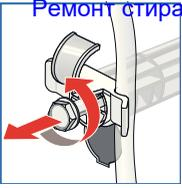
3. Отвинтите и снимите транспортные фиксирующие винты.
